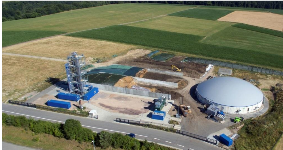
Biogas und Power-to-Gas im Energiepark Pirmasens-Winzeln; Bundesweit größte Anlage zur biologischen Methanisierung
